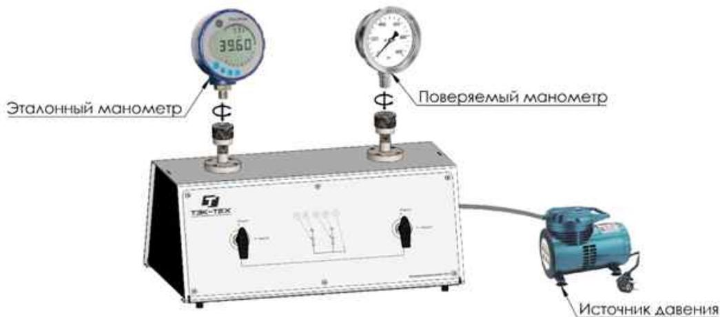
Рис. 5.1 Схема внешних соединений стенда КС-4
