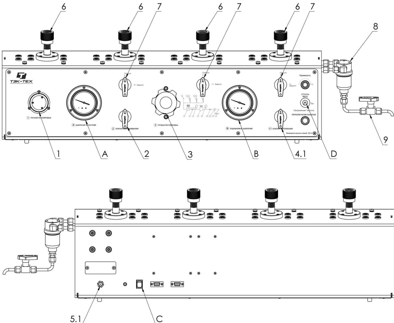
Рис. 4.1 Составные части и механизмы стенда КС-34-ЕК-К-Т-GPV-M20:
